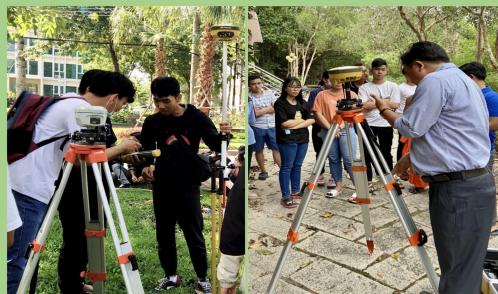
Đo ngoại nghiệp với máy RTK
